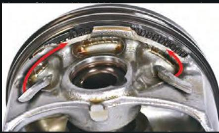
Пример повреждения поршня из-за LSPI, которое произошло во время испытания моторного масла конкурента. Красные стрелки обозначают участки кольца, которые отделились от поршня.
